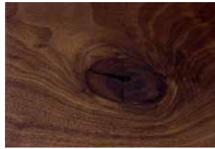
Noce con nodi, olio Walnut with knots, oil Nussbaum mit Knoten geölt
